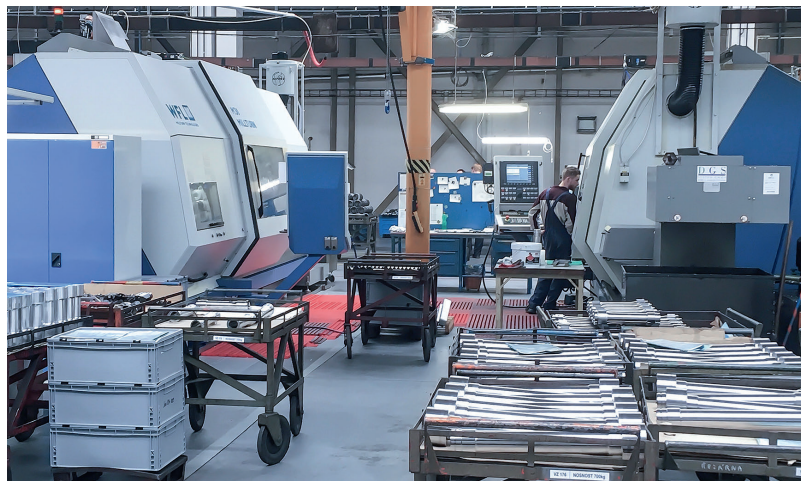
Zwei WFL-Multifunktionsmaschinen – ein Arbeitsplatz: Jihlavan fertigt auf diese Weise komplexe Hydraulikkomponenten weitgehend mit dem Komplettbearbeitungsansatz © WFL
